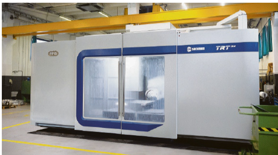
Qui sopra la Sachman TRT314, fresatrice a banco fisso con testa centesimale recentemente entrata a far parte del parco macchine OMK. A lato foto di gruppo con al centro Axel Bassani, pilota Bimota nel campionato Superbike che, per il secondo anno, OMK affianca come sponsor
